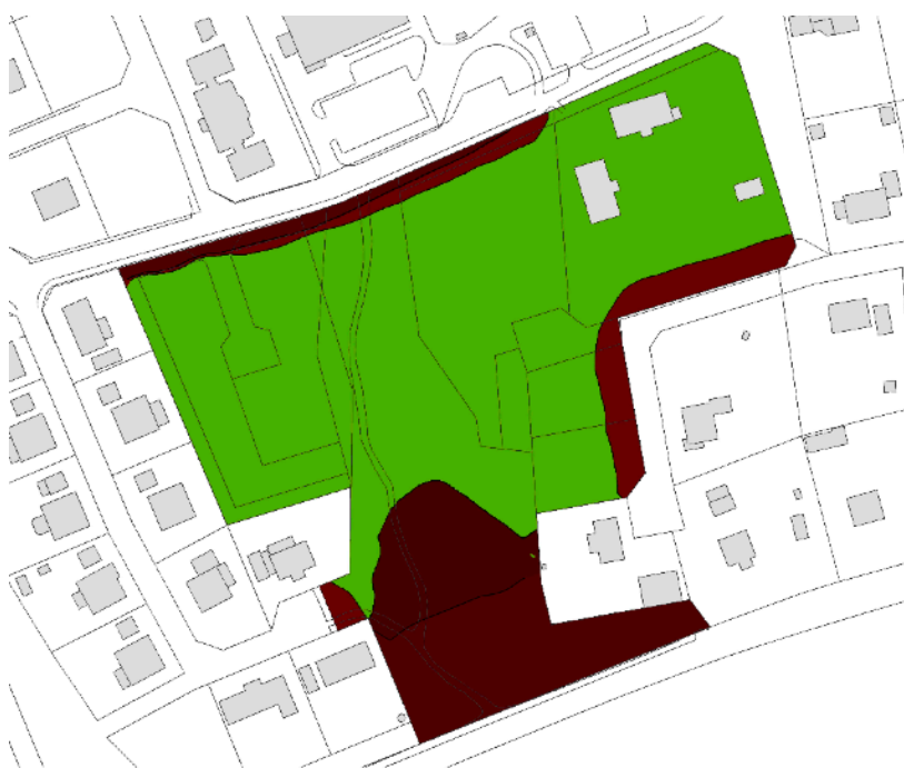
Figur 4. Gröna ytor visar var riktvärdena för uteplats uppfylls. Bruna ytor innebär att ljudnivån är för hög för uteplatser.
